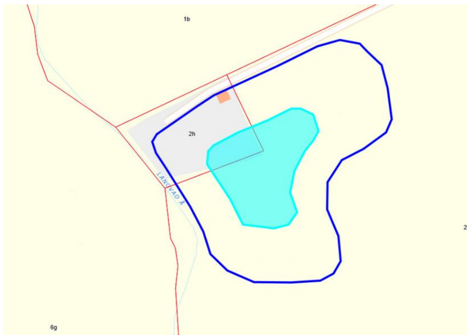
Figur 1. Kortet viser den nuværende matrikel 2h, samt de omkringliggende matrikler. De røde streger angiver matrikelgrænserne. Den lyseblå skravering skitserer udbredelsen af den permanent vandfyldte del af regnvandsbassinet. Den mørkeblå streg skitserer udbredelsen af det nye regnvandsbassin, inkl. opstuvningsvolumen samt regulering til omgivende terræn.
